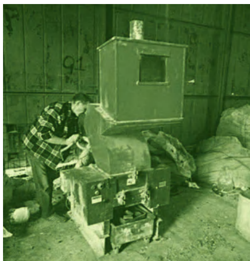
Роторная дробилка для измельчения пластика в хлопья и отправки на перерабатывающие предприятия
