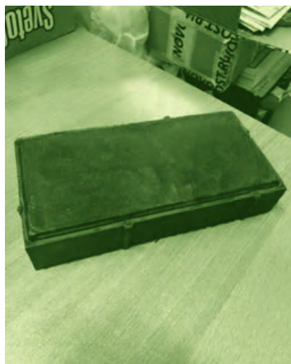
Образец полимерпесчаной брусчатки, произведенной ООО «Спецтранс»
