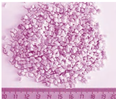
Гранула полипропилена из вторичного сырья
